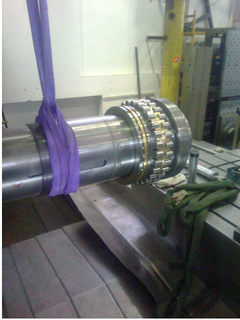
Einbau der Hohlwelle und neuer Lagerung. Lagerluft vor der Revision 0,08- 0,1 mm Nach der Revision 0,003 mm
