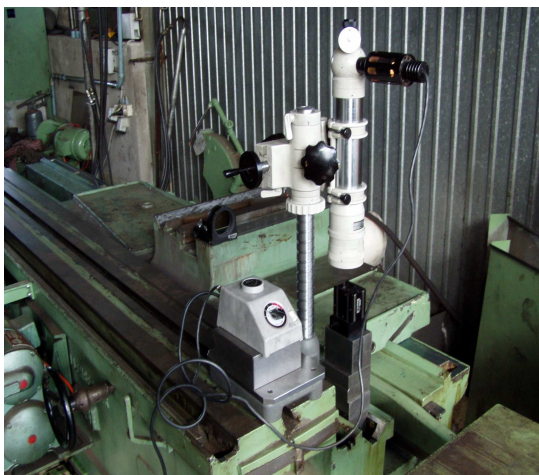
Kontrollieren und erstellen der Geometrie von Bohrwerk Wotan Rapid 1 und Umbau der CNC-Steuerung bei Wenger Maschinenbau , Ittigen b. Bern.
