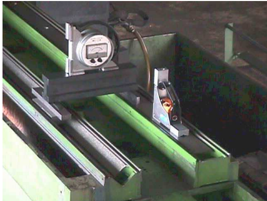
Elektronisch- und optisches Vermessen und Schaben der Prisma- Flach- Führungsbahnen einer Flachsleifmaschine Camut der Firma Müller Martini in Hasle LU.
